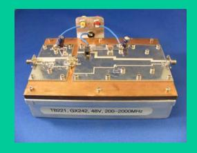
(L) GX242: 960-1260MHz, 120W P3dB, 13dB, 40%, 48Vdc (M) GX141: 1-1000MHz, 25W P3dB, 12dB, 40%, 48Vdc
